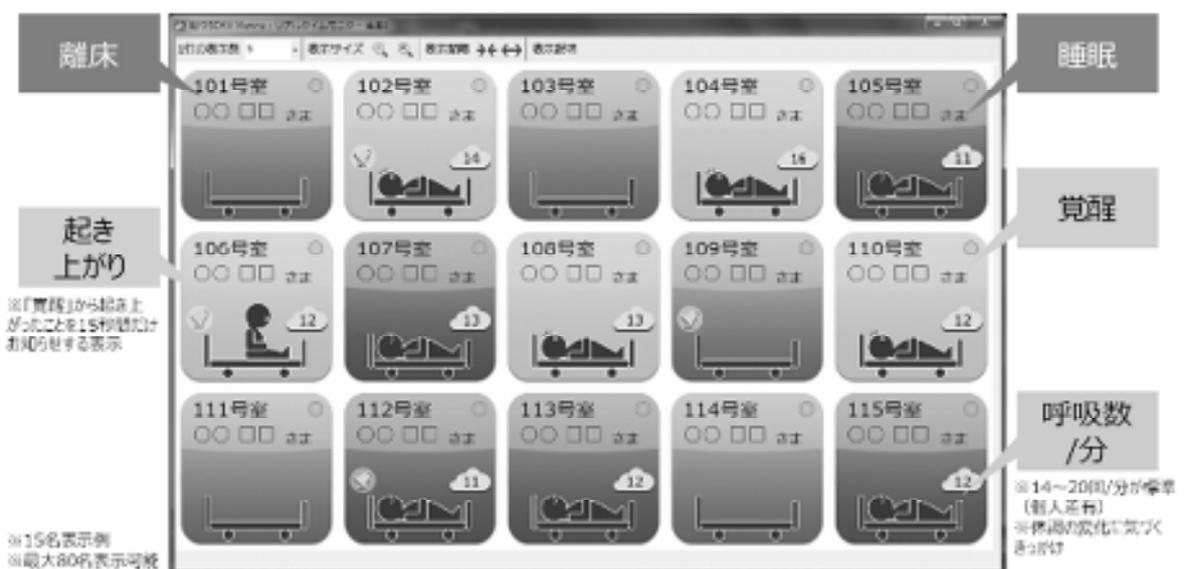
リアルタイムモニターを利用するためには、眠りSCAN本体とPCをLAN接続（有線／無線）する必要があり、さらに無線の場合はWi-Fi 通信するためのアクセスポイントも必要となる。
